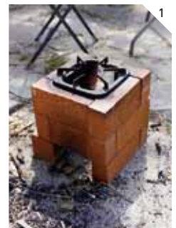
バートンネルというロケットストーブと同じ原理で上昇気流が生まれ、よく燃える。
