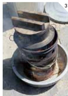
羽釜にジャストサイズ。ちょうど米が炊き上がる15分程度でもみ殻の燃焼も終わる。
