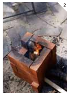
普段は横から薪をくべて、火を強くしたい時は煙突部分の上からくべる。
