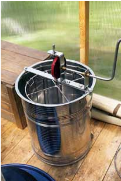
蜂の巣から蜜を取り出す遠心分離機を、洗浄・脱水できる洗濯機として使えるように改造する計画も進行中。
