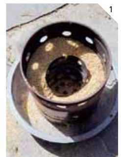
穴のあいたパール缶とアルミの水筒の間に、もみ殻を敷き詰める。この穴の感覚は研究の賜物。
