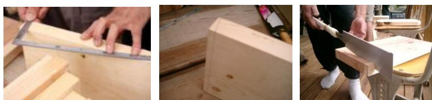
③足の部材の墨付けです。2寸勾配を差し金で墨付けします。4面に墨付けをします。
